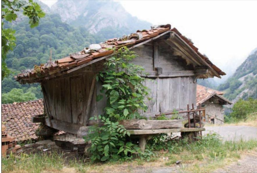
• Vista general del hórreo: la cara oeste, rematada en frontón, y la cara norte. De dimensiones limitadas, la cámara se cierra en sus cuatro lados con cureñes verticales.
